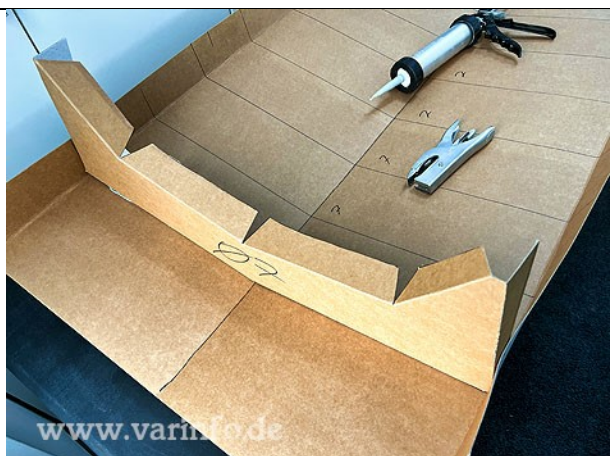
Spante 7 senkrecht auf Linie legen
