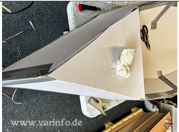
Deckel an Vorder- und Hinterteil anpassen, Nähte reinigen und wasserdicht verkleben
