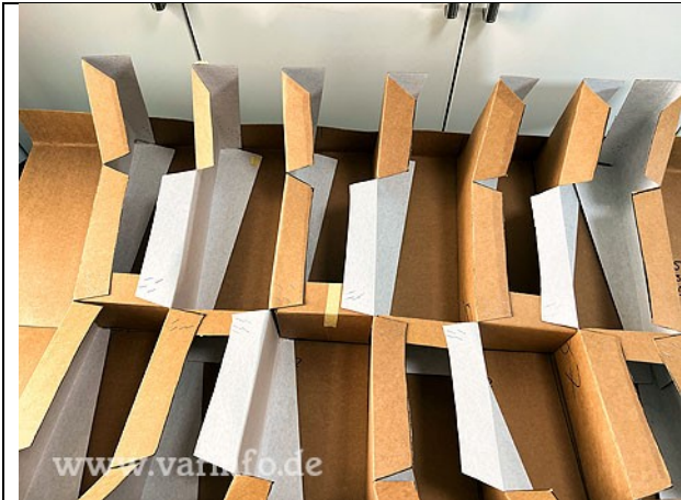
Ausrichtung und Heftung der Mittelspanten
