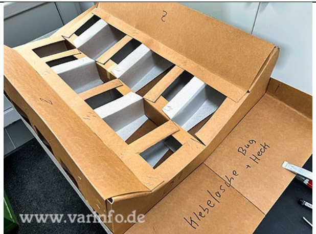
Fertige Montage des Z-Profiles
