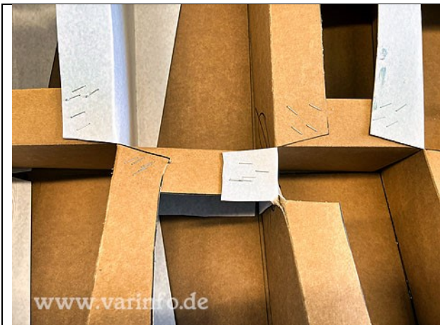
Fehlende Mittelspannen zwischen den Teilen montieren
