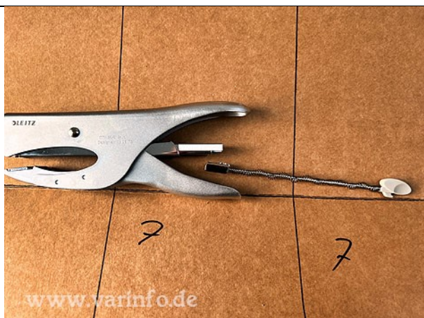
Heftzange mit bis zu zwei Klammerriegeln füllen. Bei allen Heftungen die flache Zangenseite in das Boot ausrichten!
