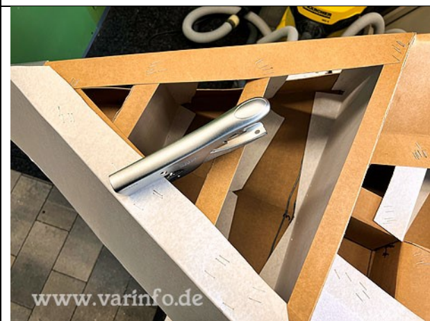
Seitenverkleidung vorne und hinten an Kartonwinkel heften
