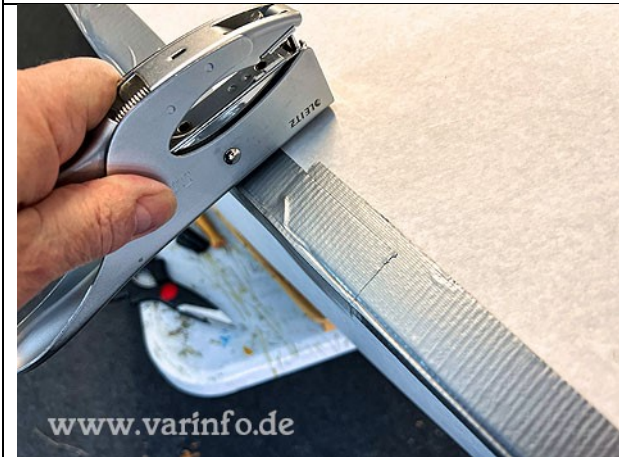
Klebeband fest anpressen und Luftblasen entfernen
