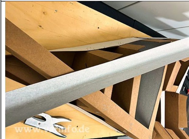
Kartonwinkel oben an Spante 1 – 3 festheften
