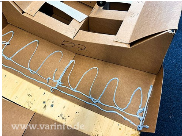
Mittelteil mit Vorder- und Hinterteil verkleben
